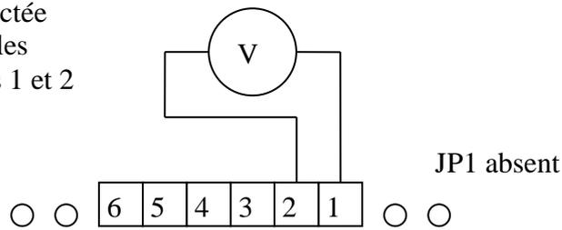
La polarité de la source de tension n'a pas d'importance, l'opto-coupleur d'entrée étant bidirectionnel.
