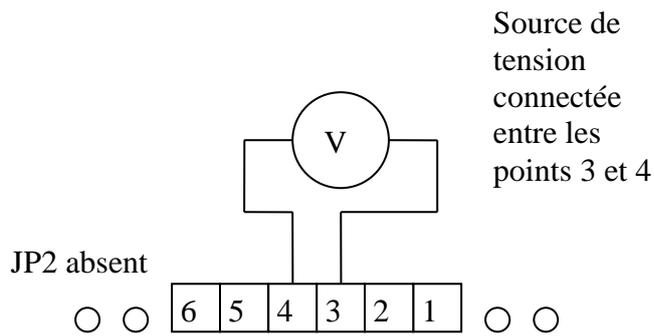
La polarité de la source de tension n'a pas d'importance, l'opto-coupleur d'entrée étant bidirectionnel.
