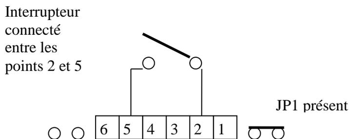
2.5.1.2 Configuration pour une entrée d'alarme 1 avec une source de tension
