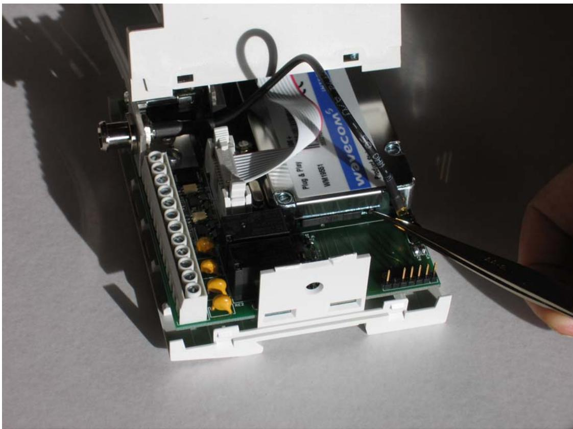
Pour déverrouiller le tiroir, appuyer avec un crayon ou un petit tournevis sur le bouton d'éjection. Le tiroir de la carte SIM sort alors de quelques millimètres :
