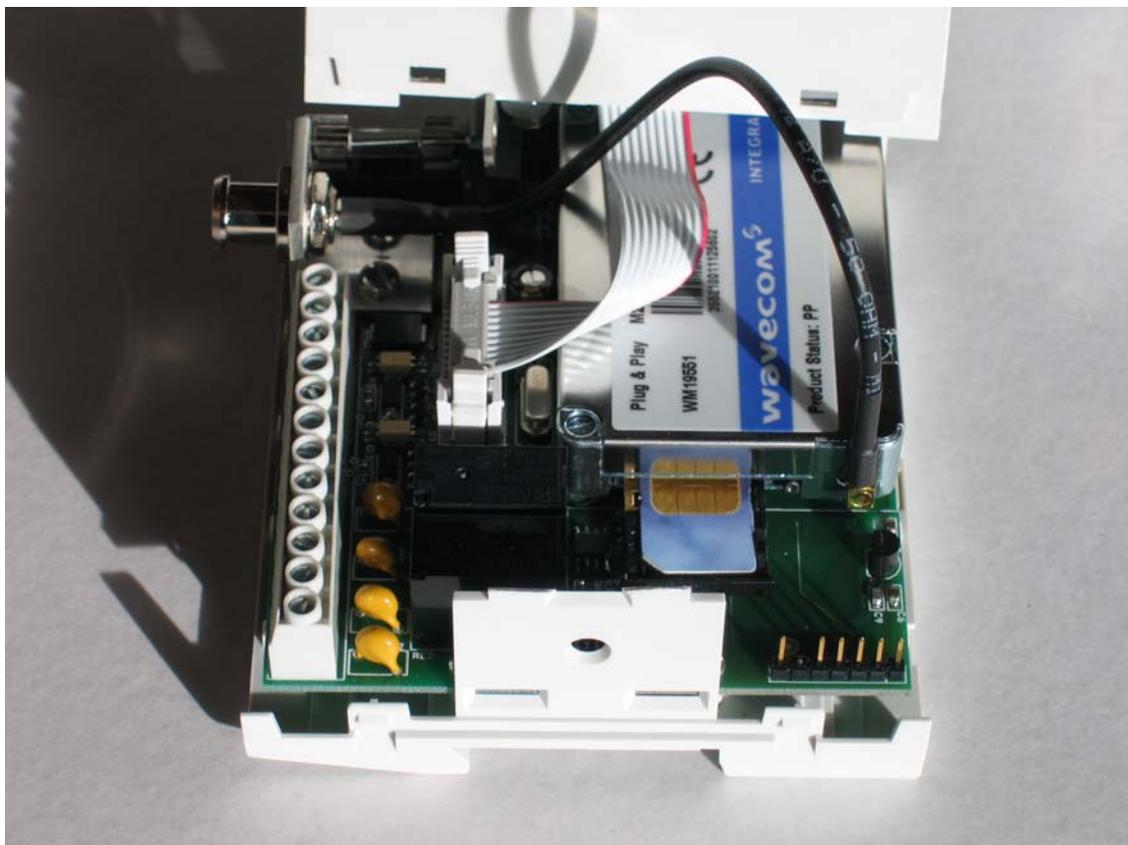
Vous pouvez dès lors refermer la boîte dans le mouvement inverse de l'ouverture. Prenez garde à ce qu'aucun fil ne gêne la fermeture. Les deux fils devraient se trouver dans la partie centrale du boîtier. Aucun fil ne doit se trouver entre le modem et le premier palier du couvercle du boîtier.
