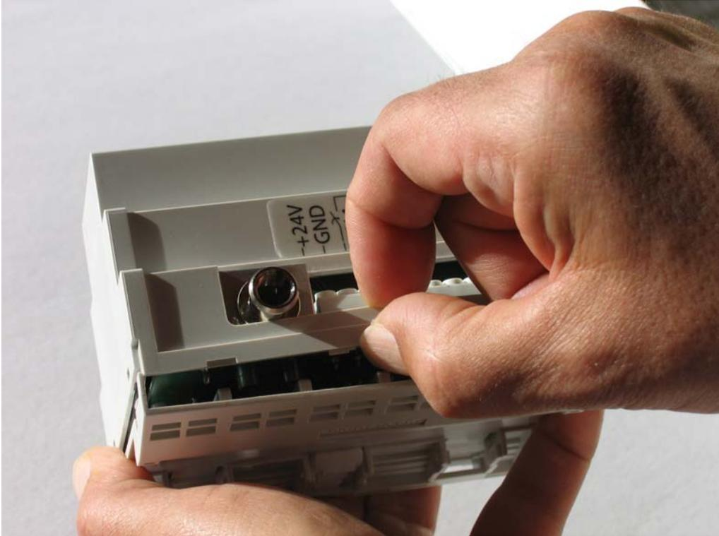
Puis soulevez l'arrière et déplacez le couvercle vers l'avant de manière à dégager le connecteur d'antenne :
