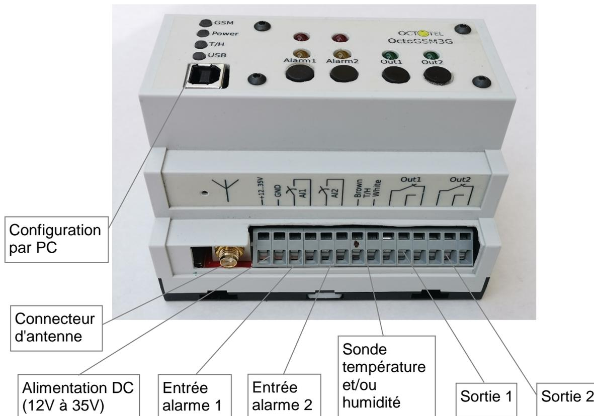
Dialogue d'utilisation par SMS au moyen d'un modem GSM 3G intégré
